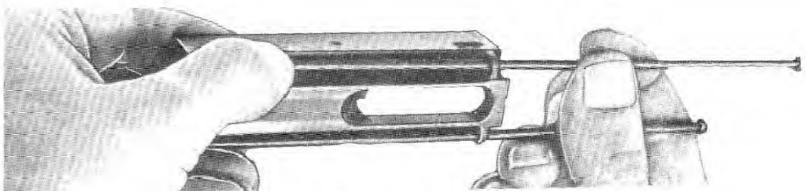
Sl. 66 – Odvajanje vodiča povratnih opruga od sklopa zatvarača
